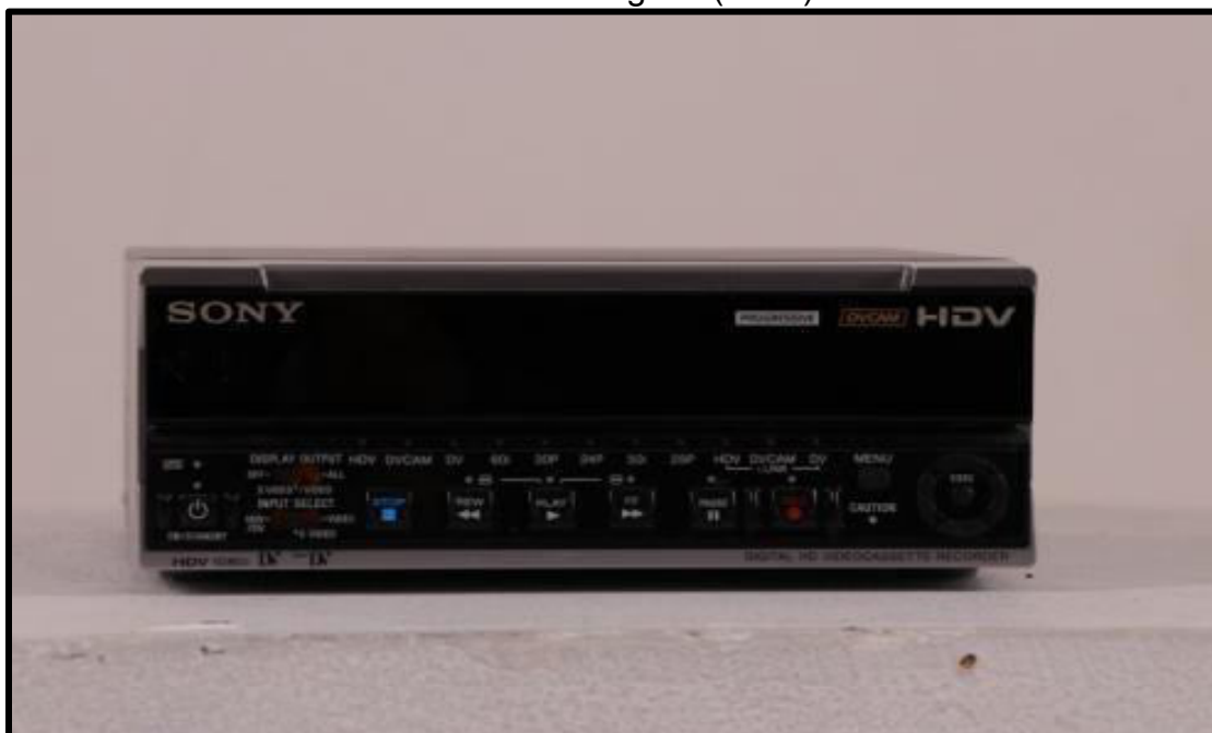
DV Cam – MDV – Marca Sony (Digital MD Videocassete recorder 8- 4V VT digital com padrão de mídia DVCam.
